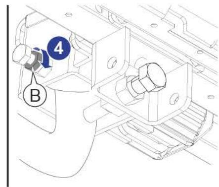
**ES** Ajuste del cabezal: Afloje la contratuerca (B), apriete el tornillo (A) hasta que el cabezal no pueda girar (en caso de que no sea posible bajar la palanca con la fuerza de la mano, afloje un poco el tornillo). Una vez se consiga un buen ajuste, apriete la contratuerca (B). Esta operación debe ser repetida cada cierto tiempo.
